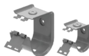
VZBG Passe-câble Hermann SI E30-E90 Distance maximale 0,8 ou 0,6m
