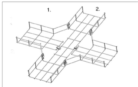
Ein Kreuzstück wird gebildet, indem man die Seitenfläche der Gitterbahn (Nr. 1) gemäß den in Tabelle aufgeführten Werte abschneidet. Bei Gitterbahn (Nr. 2) werden immer dieselben Bereiche weggeschnitten. Danach werden die verbleibenden Seiten so gebogen, dass sie genau übereinander liegen. Die Gitterbahn werden mittels VFK miteinander verbunden.
