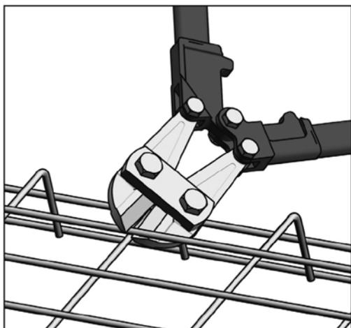
Die Gitterbahnen können durch eine einfache Schneidbearbeitung Ihren Wünschen entsprechend angepasst werden. Zum Bescheiden eines Gitter empfehlen wir die Benutzung einer Drahtschere mit gekröpfter Scheide (siehe nachstehende Abbildung).
