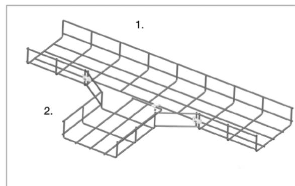
Ein T-Stück wird gebildet, indem man die Seitenfläche der Gitterbahn (Nr. 1) gemäß den in Tabelle aufgeführten Werte abschneidet. Bei Gitterbahn (Nr. 2) werden immer dieselben Bereiche weggeschnitten. Danach werden die verbleibenden Seiten so gebogen, dass sie genau übereinander liegen. Die Gitterbahn werden mittels VFK miteinander verbunden.
