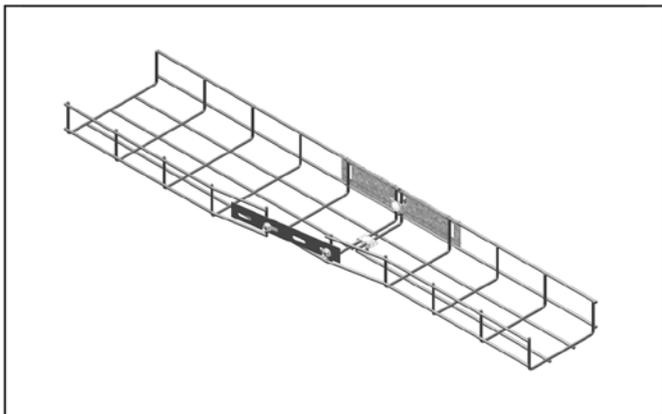
Gitterbahn können reduziert werden, um sie mit einer zweiten, weniger breiten Gitterbahn zu verbinden.
