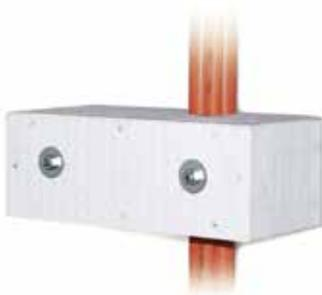
Wirksame Unterstützungs-Maßnahme bei vertikaler Verlegung, Abstand von bis zu 3,5 m über die Kabelverlegung mit DR15.30 rail und Kabelklemme HDH1. Eine mäanderförmige Kabelverlegung entfällt bei Einsatz der WUM. Entspricht der Norm DIN4102-12 Funktionserhalt.
