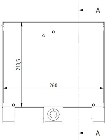
Einbaurahmen + Klappdeckel + Kabelauslass aus Edelstahl + Alurahmen
