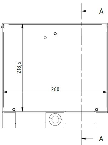
Cadre encastrable avec bord + cadre de carrelage + passage de câbles en inox
