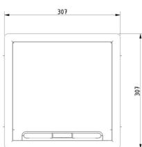
Cadre encastrable avec bord + cadre de carrelage + passage de câbles
