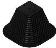
Pied de construction pour la mise en place stable de systèmes de support de câbles de poids léger à moyen sur les toits. Raccordements mécaniques par 3x trous de vis M6 dans la partie supérieure. Rempli de béton.
